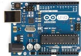
Así, podemos definir *hardware* como "toda parte física, compuesta de un conjunto de componentes electrónicos y piezas que hacen que el equipo funcione". Por lo tanto, cualquier dispositivo electrónico, como computadora, *smartphone*, *tablet*, *smartwatch*, entre otros, tiene *hardware*.
